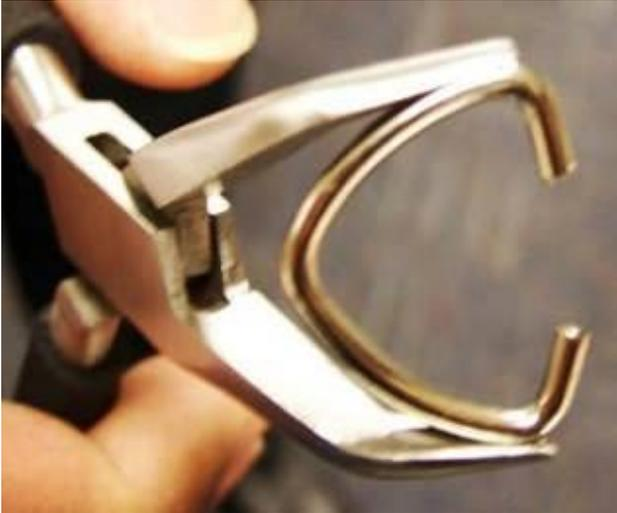
6. Placer l'extrémité ouverte de l'anneau "D" dans les trous de la pointe de la baguette et presser l'anneau "D" pour fermer
