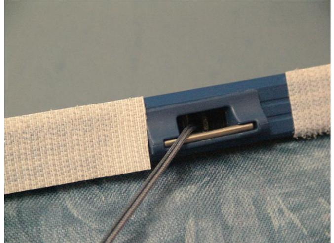
3. Placer le cordon loin de la serrure de cordon. Insérez un tournevis plat dans le guide en plastique noir. Pour un contrôle à gauche, faites glisser le guide noir vers la droite. Pour un contrôle à droite, glissez le guide noir vers la gauche. Une fois terminé, le store devrait fonctionner correctement.
