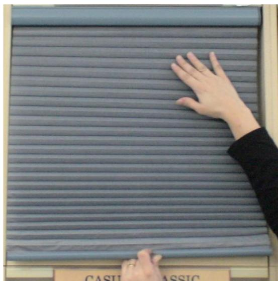
3. Si les étapes 1 et 2 n'ont pas corrigé le problème, soulever le store complètement. Enlevez le store des supports d'installation en utilisant un tournevis plat. Insérer le bout du tournevis entre l'arrière du rail de retenue et le support.
