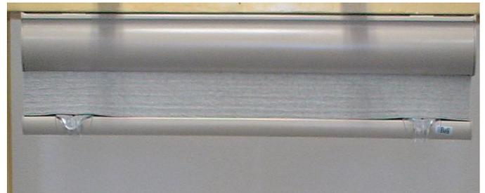
**Remarque:** L'air est emprisonné dans les cellules et quand les cellules sont soulevées l'air est poussé à sortir vers les extrémités ouvertes. Si les cellules sont soulevées trop vite, l'air génère une résistance qui empêche les extrémités d'empiler correctement et donne l'apparence courbée au rail de bas.
