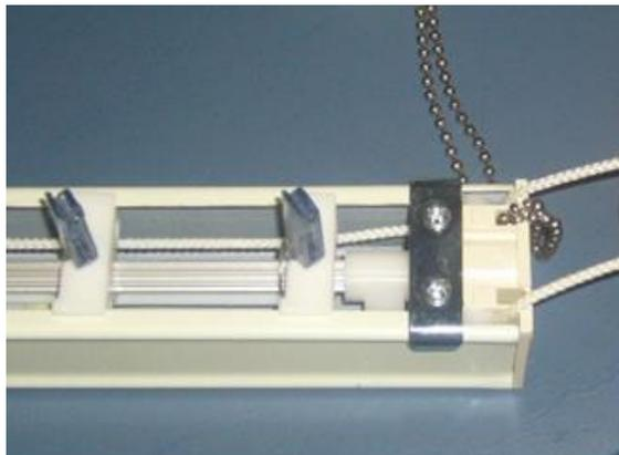
7. Si la vis Allen originale est toujours en place, manuellement tirer les chariots de têtes jusqu'à ce qu'ils joignent l'entretoise et serrer la vis Allen à l'aide d'une clé Allen de 1/16 de pouce. Tirer sur le cordon de déplacement pour essayer. Toutes les deux sections devraient traverser maintenant.
