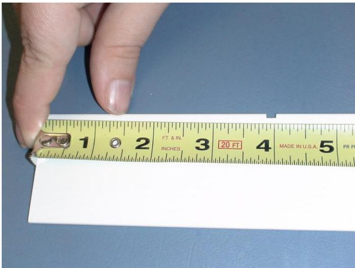
3. Avec le ruban à mesurer toujours sur le côté gauche de la lamelle, mesurez jusqu'au milieu de la deuxième encoche. Notez cette mesure.
