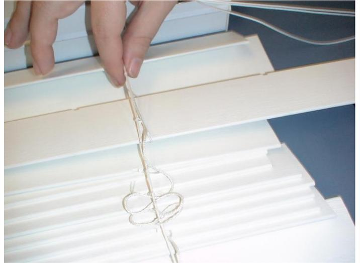
2. En utilisant un ruban à mesurer en métal mesurez à partir l'extrémité gauche de la lamelle au milieu de la première encoche. Notez cette mesure au plus proche de 1/16 po.
