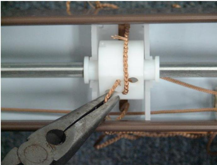
6. Utilisez pinces nez aiguille pour ouvrir l'œillet de laiton à l'extrémité de l'échelle sur le côté suspendus trop élevé. Glissez l'œillet vers la fin de la corde de l'échelle et utilisez de pinces nez aiguille à pour re-sertir. Utilisez l'emplacement de l'œillet de laiton sur une échelle de cordon différent comme guide. Tous les œillets doivent être situés à la même position sur toutes les échelles pour assurer le niveau de stores.
