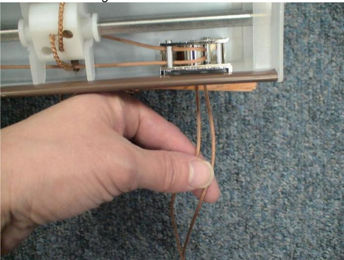
4. Si l'un des côtés de la lamelle de haut semble plus haut que l'autre, la bande d'échelle peut-être pris dans les supports. Tirer doucement vers le bas sur la bande d'échelle entre les supports et la lamelle en haut sur le côté qui ressemble le plus élevé.
